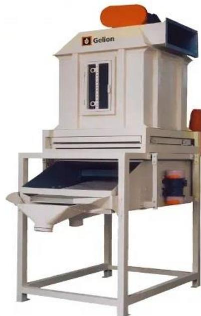
Колонны охлаждения автоматические SNa предназначены для воздушного охлаждения гранул после их выхода из пресс-гранулятора. В колонне охлаждения воздушный поток, двигаясь во встречном направлении к подаче гранул, отводит излишнюю влагу, снимает тепло, очищает гранулы от крошки и пыли. После прохождение через колонну гранулы становятся прочными, готовыми к транспортировке и длительному хранению.
